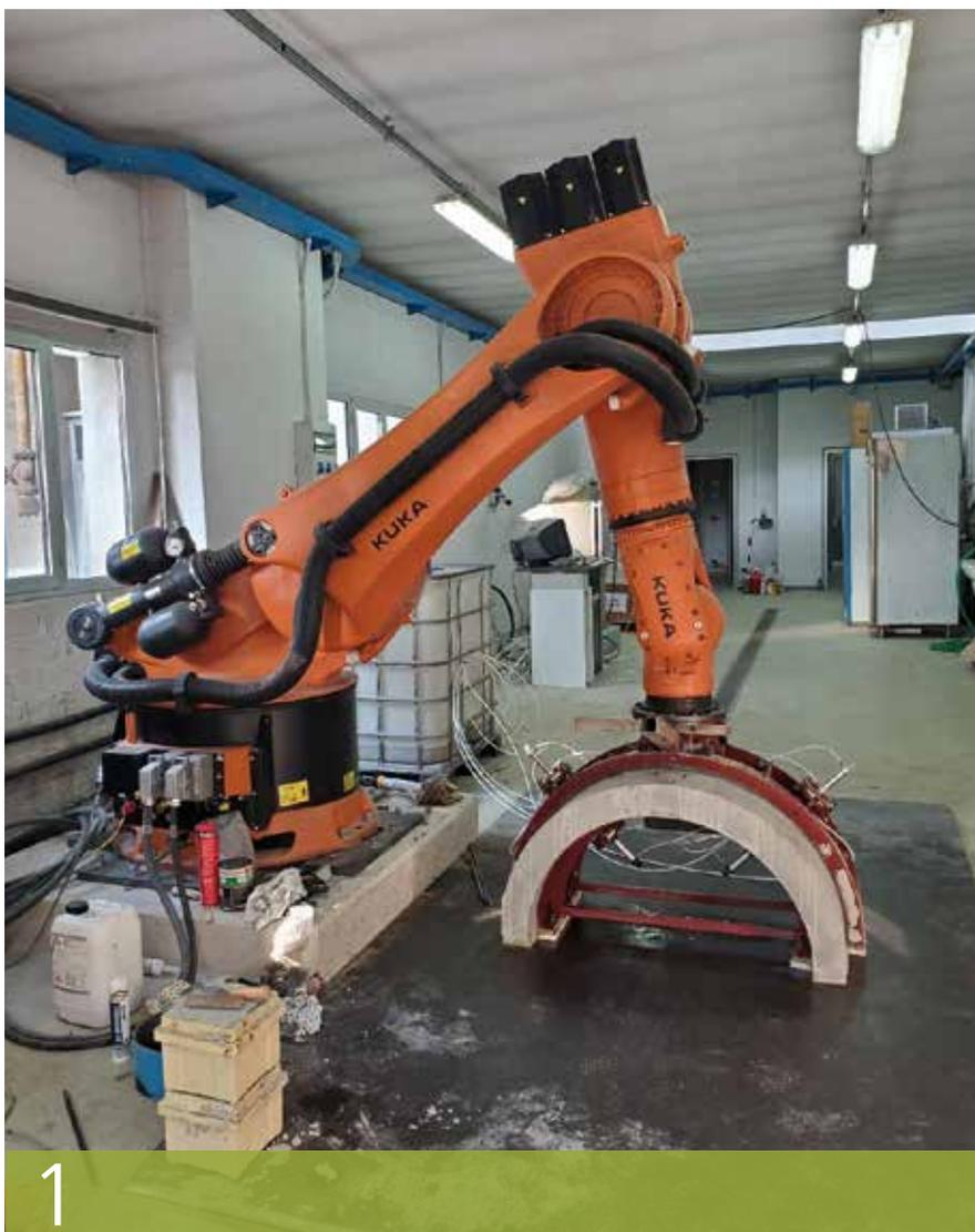
1. IL ROBOT DI ESTRUSIONE SPERIMENTALE PRESSO IL LABORATORIO DI TRINO
